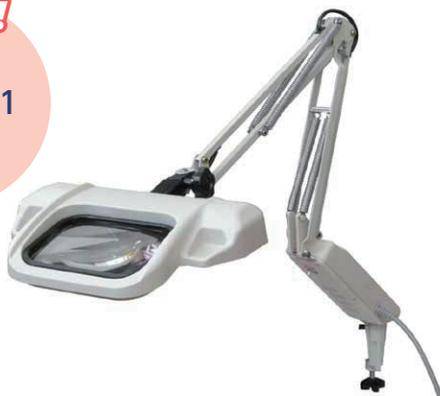
パネル型LEDをレンズ後方に装着した方位照明を採用し、ワーク表面へ角度を付けた光線を照射することでワーク表面の異常の可視化に効果があります。マルチコート仕様の製品はレンズ表面の光線反射を抑制し、使用者の負担を軽減します。倍率は2倍と3.5倍(標準/ARコート)で、RECTA-PULを使用すれば4倍、5倍へ変更可能。
