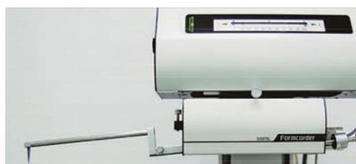
EF651D は検出器にデジタルスケールを採用してさらに高精度・高分解能
