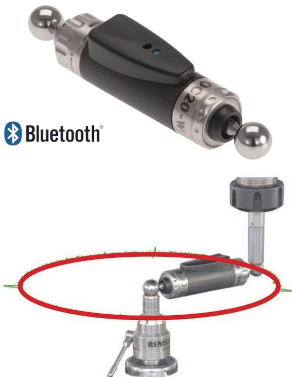
プログラム通りに加工したのに精度が出ていなくてワークがオジャン。時間の無駄と、高価なワーク代のダブルパンチに泣かされる事ってありますよね。実は機械の位置決め精度が原因な事が結構多いんです。そこで必須なのがレニショーのボールバーシステム。わずか10分のテストで機械のX,Y,Zのテスト平面で円弧を描いて半径偏差を正確に測定、レポートング出来るんです。これなら加工不良のコストも、機械停止時間の損失も、メンテナンスコストのカットまでもが出来ちゃうんです。
