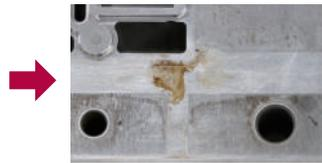
●ガス油汚れ\_洗浄後(超音波)
