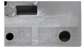
●ガス油汚れ\_洗浄後(CPV)
