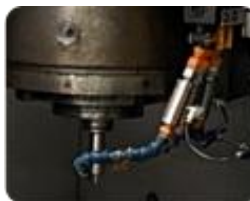
設置例2 ロックラインの途中で それぞれのロックラインに接続
