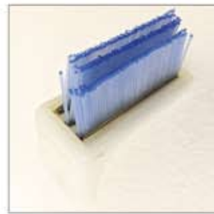
■ BA12-30L 標準ブラシの毛丈を短くしました。アタック力が上がり、1次バリから2次バリに適しています。毛丈が短い分作業時間の短縮も可能です。 ※ワークによっては傷がつく場合があります。
