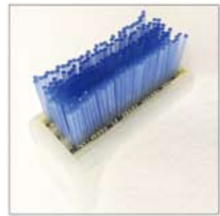
■ BA15-30L 強バリ用ブラシの毛丈を短くしました。1次バリや、なかなかしぶといバリに適しています。毛丈が短い分、作業時間の短縮も可能です。 ※ワークによっては傷がつく場合があります。
