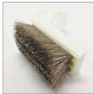
■ BC03-30L 鋼線製 鋼線製の毛先で毛丈を短くすることで高いアタック力を発揮します。研削力が高く、厚さ0.5mmの根元残りを取れる可能性があります。アタック力が高くなったため、ワークが負けて多少傷が残ることがありますが、どうしても取りたい方におすすめです。
